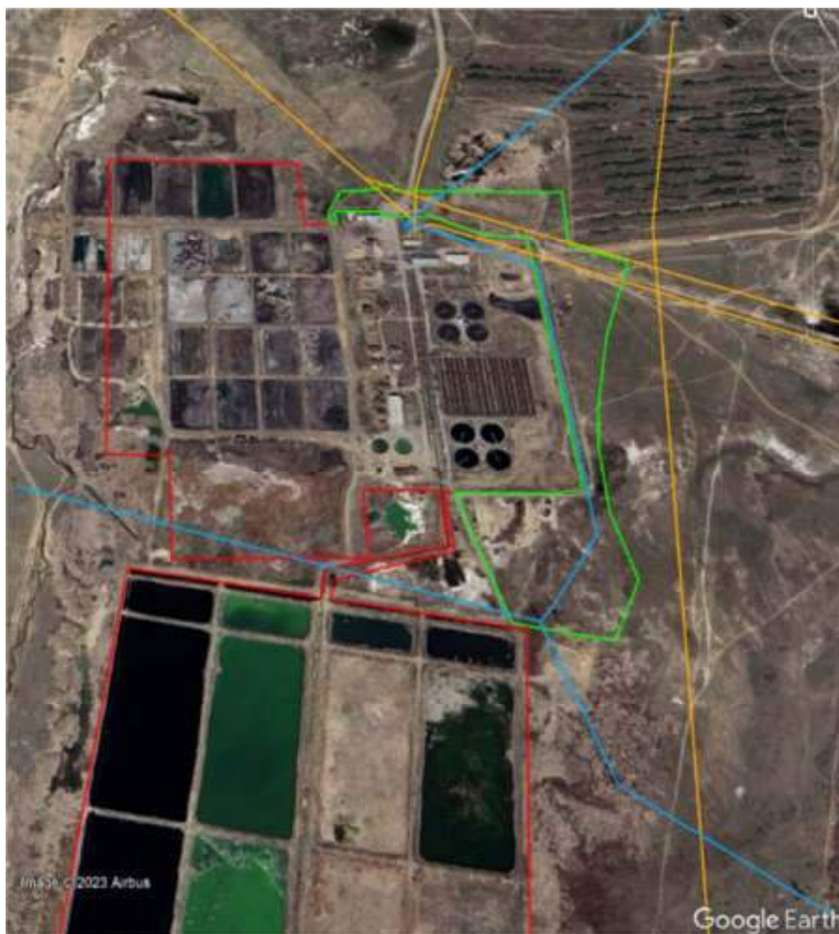
Сурет 3-8 Қолданыстағы әуе электр желілері және жаңа АСТҚ үшін ұсынылған алаң (көк: 35 кВ әуе электр желісі. Қызғылт сары: кернеуі 6 кВ әуе электр желісі).
