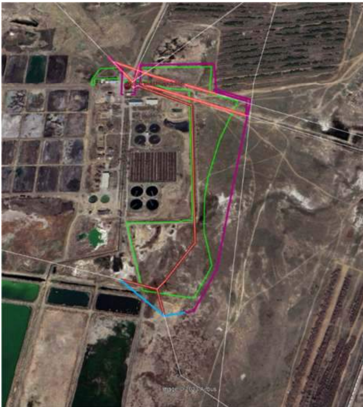
Сурет 3-9 Ұсынылған жаңа жер асты кабельдері (күлгін сызықтар) және қолданыстағы электр желілері алынып тасталады (ақ үстінде қою қызыл: 35 кВ ӘЭЖ, ақ түсте ашық қызыл: 6 кВ әуе желілері) және және жер асты кабельдерімен (күлгін) немесе учаскенің оңтүстігіндегі 35 кВ әуе желісінің қысқа бөлігімен (көк сызық) ауыстырылады.
